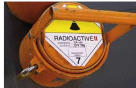
Typische Transport- und Aufbewahrungsbehälter für radioaktive Quellen
