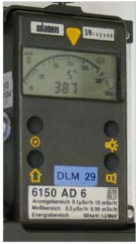
Gerät zur Messung der Dosisleistung (hier Anzeige 3,43 µSv/h)
