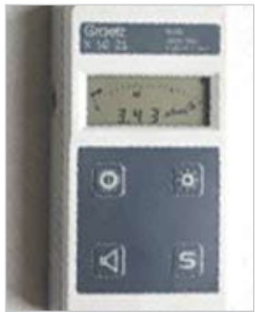
Gerät zur Messung der Dosisleistung (hier Anzeige 3,43 µSv/h)
